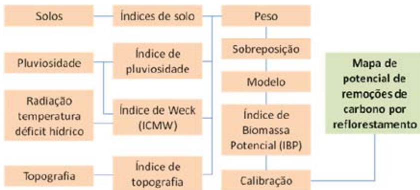
Figura 17: Diagrama de construção do modelo de potencial de fixação de carbono para os biomas do Cerrado e da Mata Atlântica
