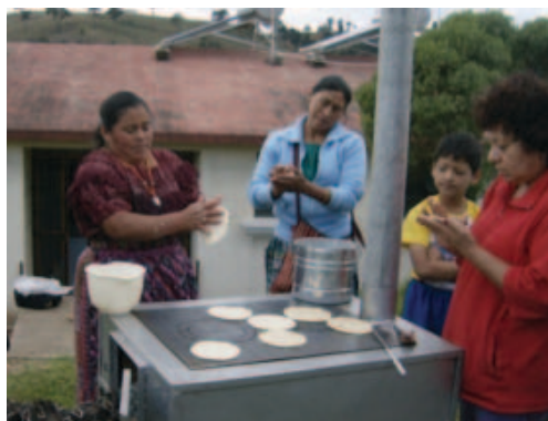
FIGURA 13. Estufa Noya con Anillos Removibles en la Plancha
